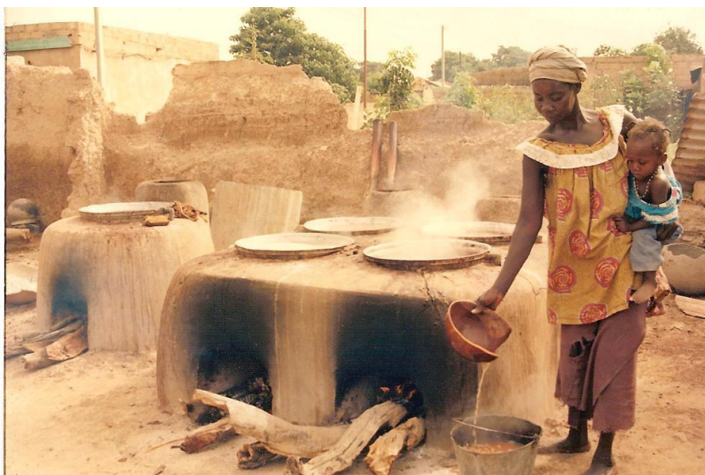
Photo 51: Foyer dolo en banco
