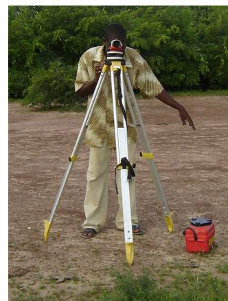
Photo 8 : le technicien viseur indique le décalage à effectuer
