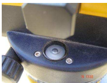
Photo 7 : mise à niveau du viseur
