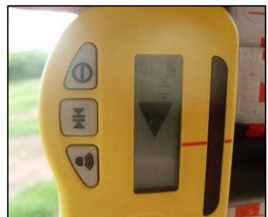
Photo 6 : flèche indiquant la direction du rayon laser
